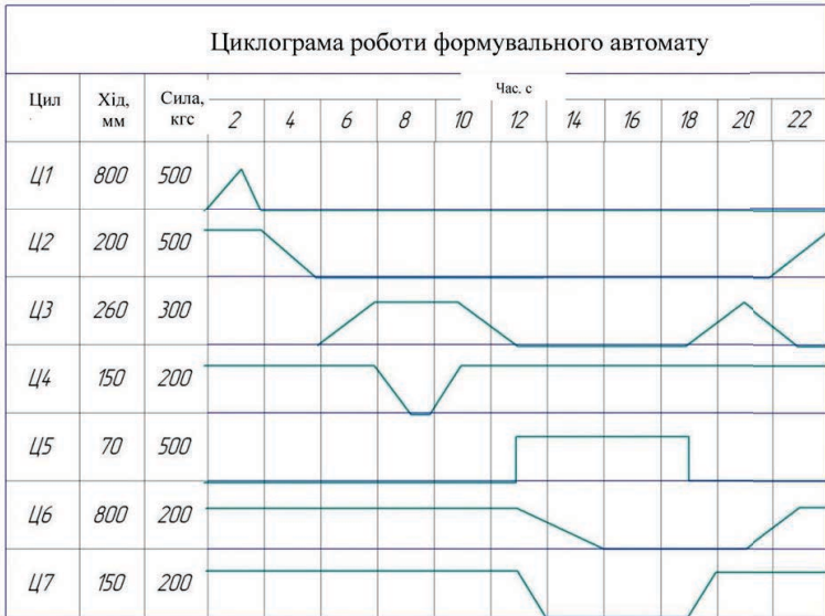
Рис. 6.2 – Циклограма роботи формувального автомату
